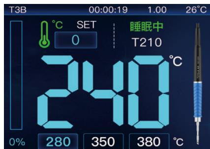
工具长时间置于支架中后，温度会自动下降至预设睡眠温度。
